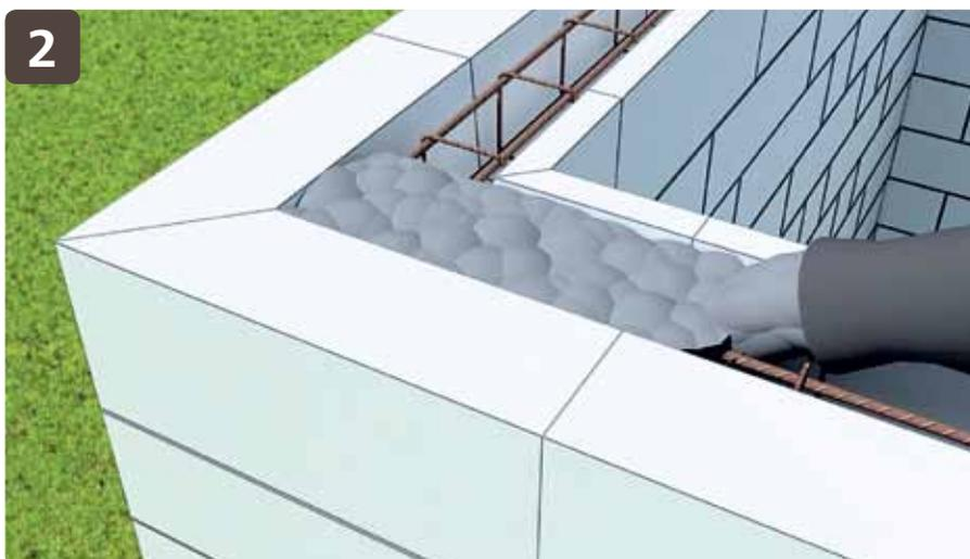
Затем необходимо уплотнить бетон штыкованием при помощи вибратора.
