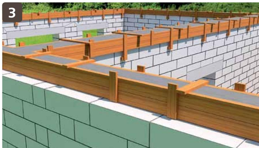
С целью предотвращения возникновения «мостика холода», армопояс утепляют. Для этого с наружной стороны стены к армопоясу прикрепляют минераловатный утеплитель.
