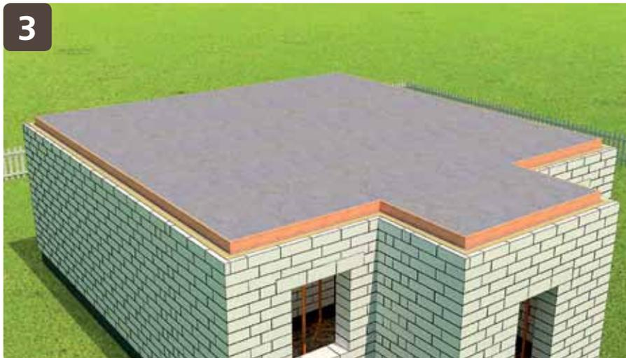
С целью предотвращения возникновения «мостика холода», плита перекрытия утепляется со всех сторон минераловатным утеплителем.
