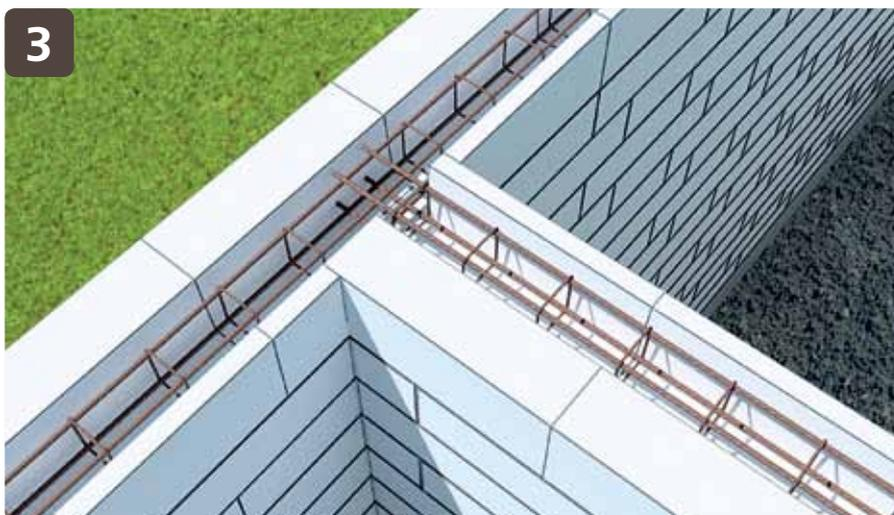
Стыковка арматуры в углах является особенно важной. Поэтому узлы сопряжения арматурных каркасов следует выполнять, как указано в проекте.
