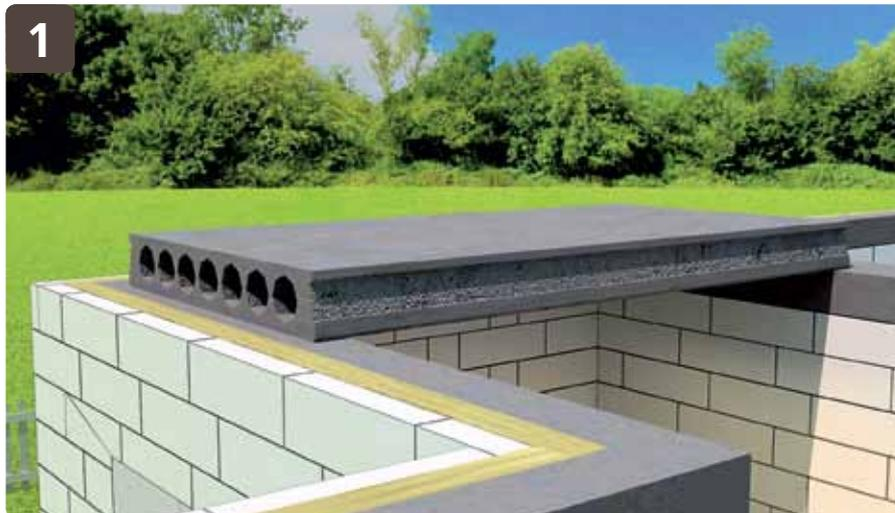
Плиты монтируются способом «на весу» при помощи кранов.
