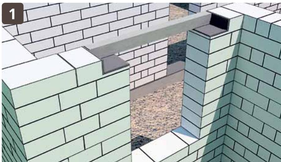
Чтобы не возник мостик холода, коэффициент теплопередачи перемычек должен быть приблизительно таким же, как коэффициент теплопередачи стены. Этого можно достичь только в случае, если слой теплоизоляционного материала (минеральной ваты) будет толщиной не менее 10 см.
