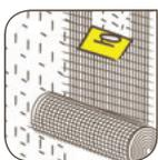
Раствор наносится зубчатым шпателем из нержавеющей стали (размер зуба 10–12 мм) на всю поверхность теплоизоляционной плиты. Перед созданием базового штукатурного слоя минеральные плиты грунтуются тонким слоем клеевого раствора. В свежий слой клеевого раствора укладывается армирующая щелочестойкая стеклосетка (например, R131) и
