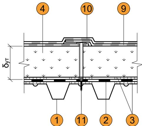
Б. Однослойная изоляция с устройством сборной стяжки
