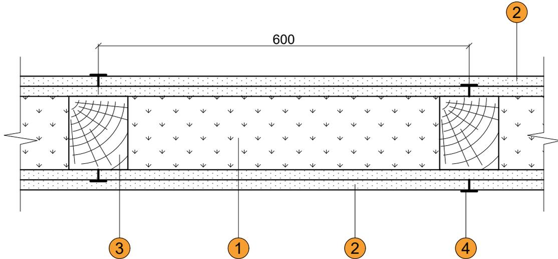
Узел соединения гипсокартонных плит
