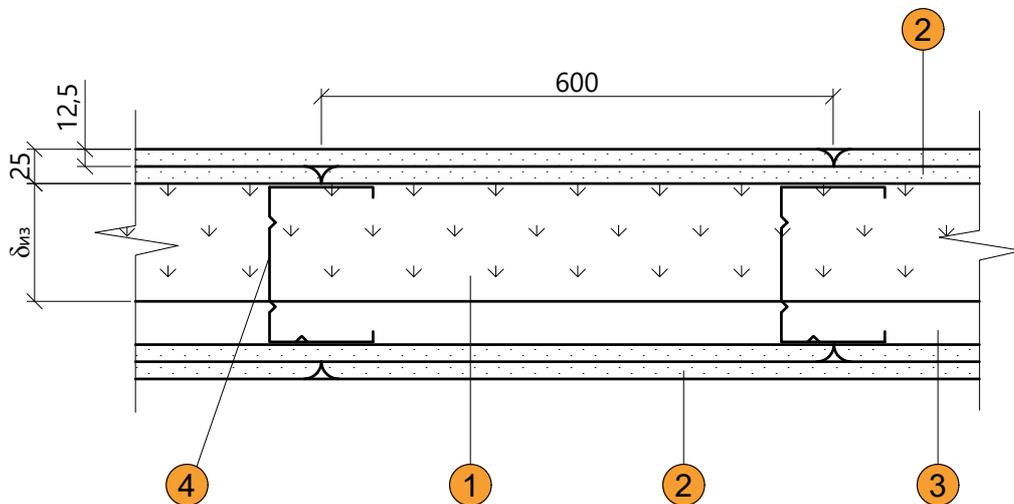
Узел соединения гипсокартонных плит
