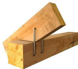
Рисунок 1 – Виды креплений стропилы к мауэрлату
