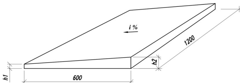
Для создания уклонообразующего слоя с уклоном 1,67% используются следующие сочетания элементов:
