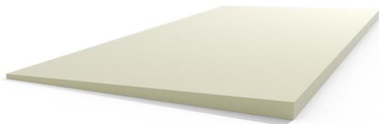
**PirroSlope** – изделия из жесткого пенополиизоцианурата (PIR), позволяющие создавать уклонообразующий слой на плоских основаниях (железобетон, профнастил) и формировать контруклоны по слою теплоизоляции. Плиты выпускаются с уклоном верхней поверхности 1,67% (элементы А, В, С, D), 3,33% (элементы J, K) и 8,33% (элемент R), а также без уклона в качестве доборных элементов (элементы Q). Доборные элементы поставляются с облицовками алюминиевой фольгой.
