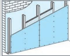
**С 625** Конструкция – металлический каркас из ПС- и ПН-профилей, обшитый одним слоем малоформатных КНАУФ-листов.
