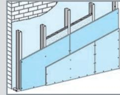
**С 626** Конструкция – металлический каркас из ПС- и ПН-профилей, обшитый двумя слоями малоформатных КНАУФ-листов.
