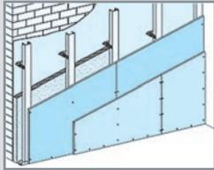
**С 623** Конструкция – одинарный металлический каркас из ПП- и ПН-профиля, прикрепленный к базовой стене при помощи прямых подвесов с шагом 1,5 м и обшитый одним или двумя слоями малоформатных КНАУФ-листов.
