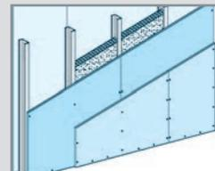
С 112 Конструкция – одинарный металлический каркас, обшитый двумя слоями малоформатных КНАУФ-листов с обеих сторон.
