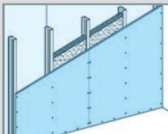
С 111 Конструкция – одинарный металлический каркас, обшитый одним слоем малоформатных КНАУФ-листов с обеих сторон.
